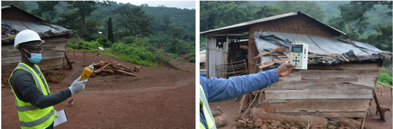
Photo 1: Exemple de mesure de gaz et de matières particulaires
